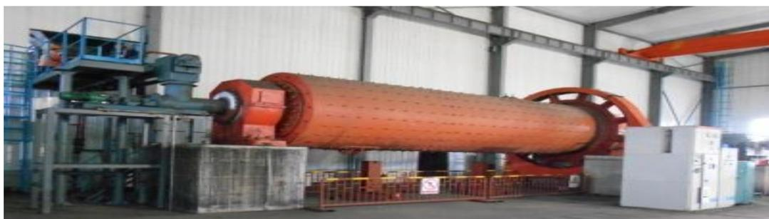
图 4：新型水煤浆生产球磨机图
